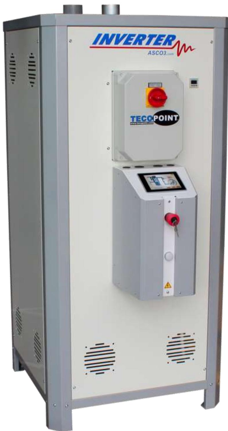
• Turbina di aspirazione polveri di carteggiatura progettata e realizzata per l'aspirazione delle polveri derivate dalla carteggiatura a secco di fondi e stucchi in carrozzeria. Per il funzionamento a vuoto la macchina e' dotata di un aspiratore a canale laterale con motore accoppiato direttamente alla girante progettata per lavorare a servizio continuo.
